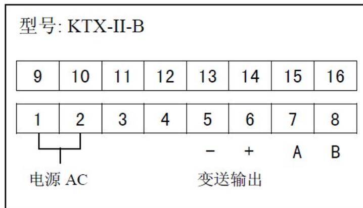
说明：变送输出电压等于供电电压，给连接设备供电。
